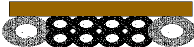
Figura 7.13. Esquemas para la contención y estabilización de suelos hasta 2,50 metros de altura
