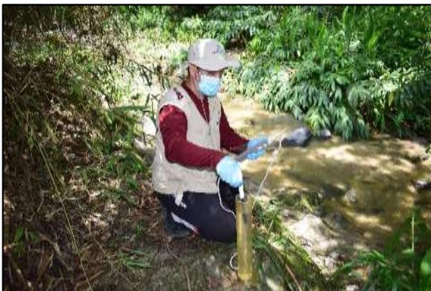
Medición de pH en campo, mediante método electrométrico.
