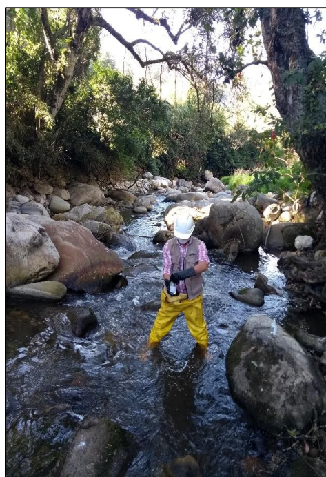
Toma de muestra para analisis de Oxigeno Disuelto
