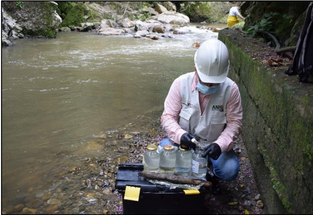
Preservación de muestras para ensayos de aceite y grasas e hidrocarburos
