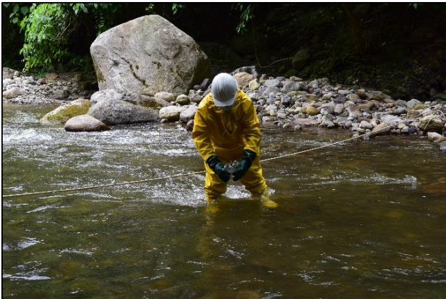
Toma de muestra para ensayo oxígeno disuelto
