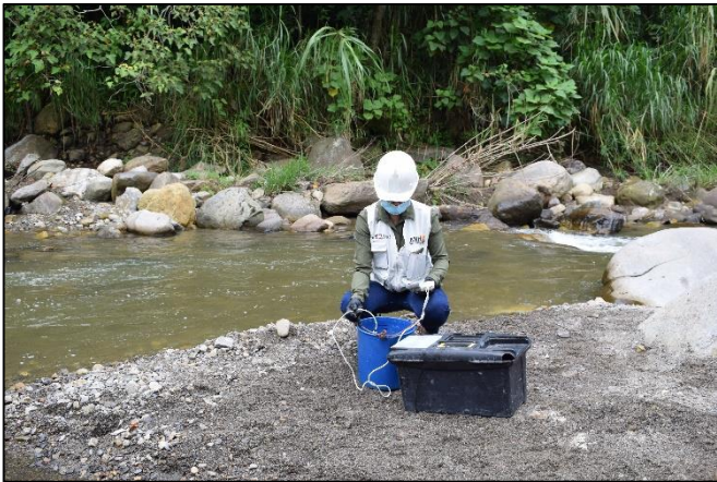
Medición de ensayo pH y temperatura
