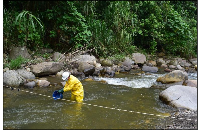
Toma de muestra para ensayos fisicoquímicos
