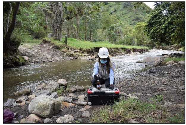
Preservación de muestra para ensayo Hierro total
