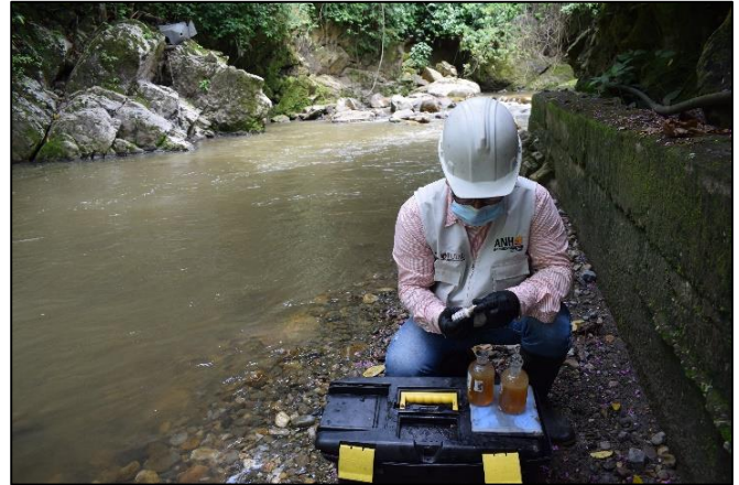
Fijación de muestra para determinación de Oxígeno disuelto
