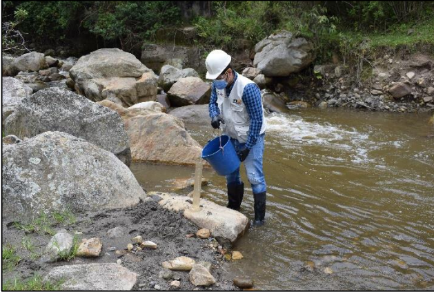
Toma de alícuota para muestra compuesta
