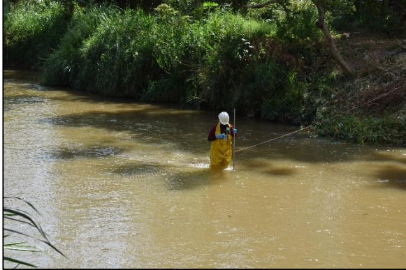
Medición de caudal
