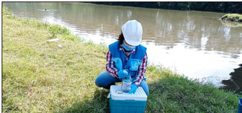
Preservación de muestras para ensayos de grasas y aceites e hidrocarburos
