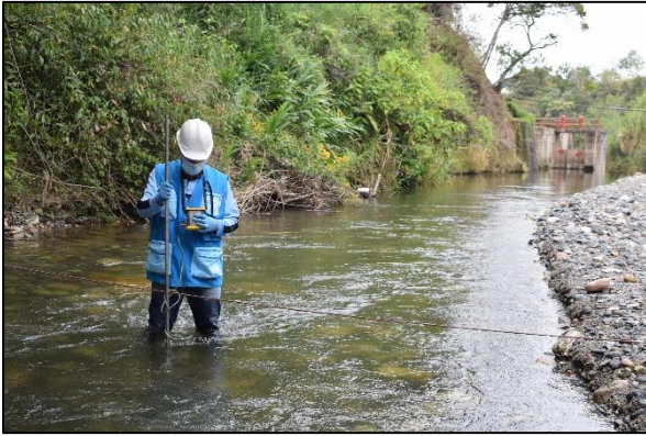
Medición de caudal
