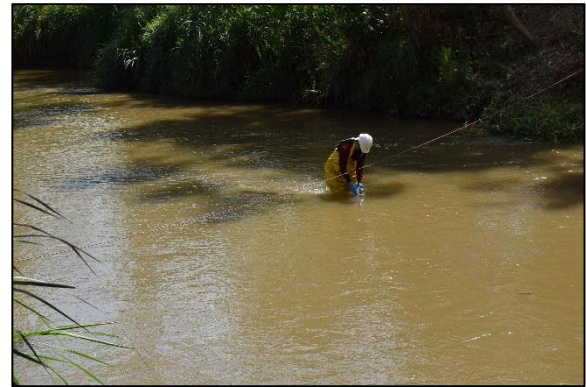
Toma de muestra para ensayo de Grasas y aceites e hidrocarburos
