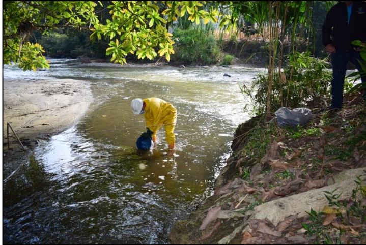
Toma de muestra para ensayos fisicoquímicos
