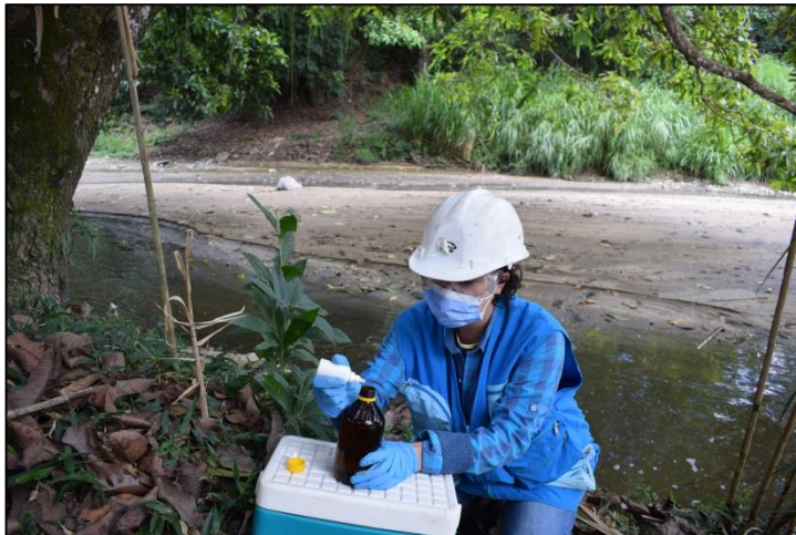
Preservación de muestra para ensayo de Hierro total
