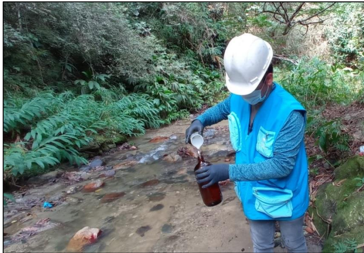
Medición de alícuota para muestra compuesta de NT, DQO, PT
