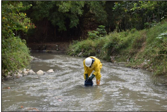
Toma de muestra para ensayos fisicoquímicos
