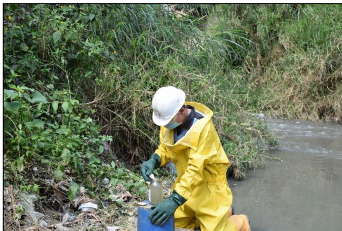
Preservación de muestra para ensayo de Grasas y Aceites e Hidrocarburos
