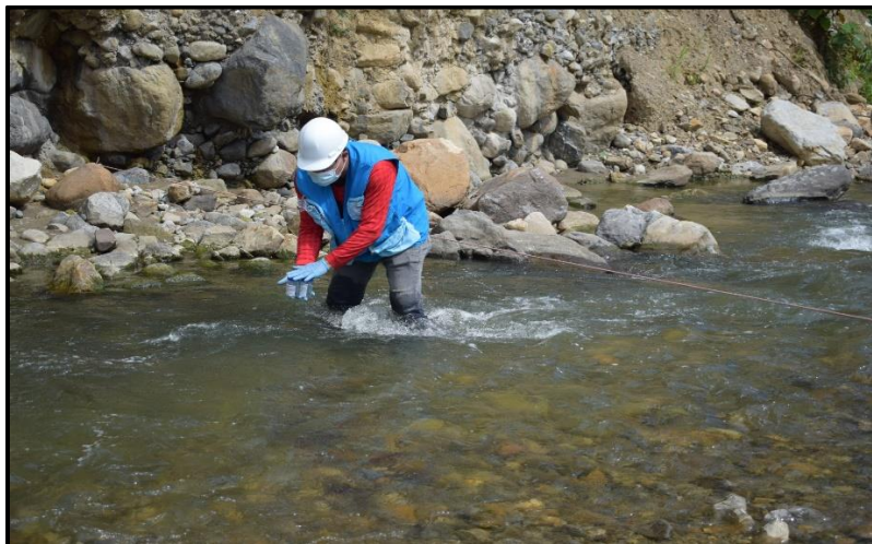
Toma de muestra microbiológicas para determinación de Coliformes totales y E. Coli
