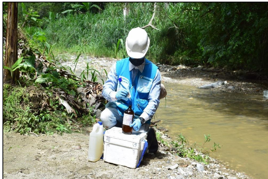
Preservación de muestra para ensayo de NT, PT y DQO
