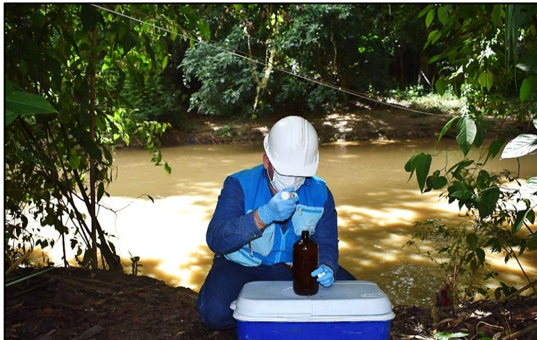
Preservación de muestra para ensayo de NT, PT y DQO
