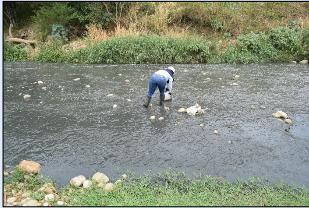
Toma de muestra para ensayos fisicoquímicos.
