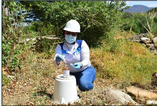
Preservación de muestra para el parámetro de Oxígeno Disuelto.
