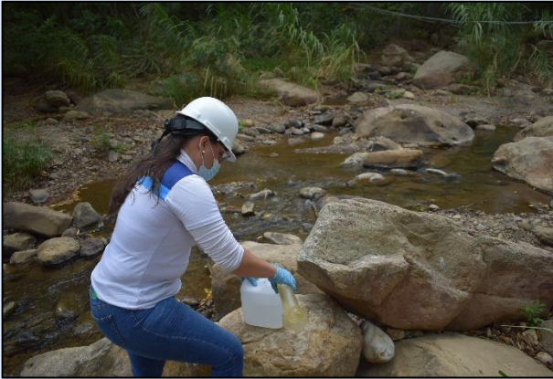
Toma de muestra alícuota para análisis para ensayos fisicoquímicos.
