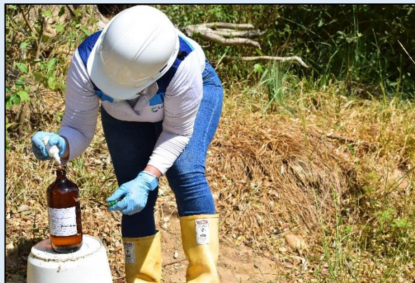
Preservación de muestra para el parámetro de Nitrógeno Total- NT.
