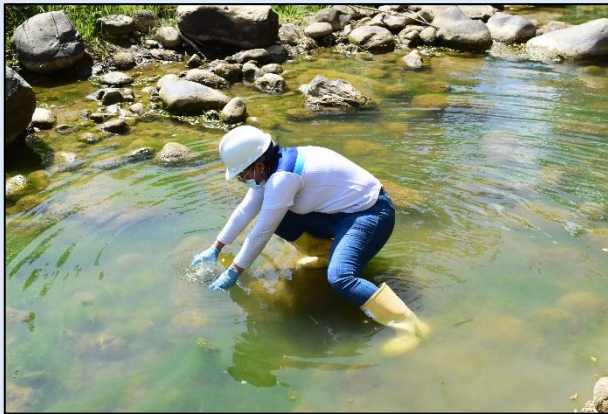
Toma de muestra para el ensayo de Oxígeno Disuelto.
