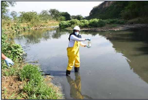
Toma de muestra para ensayos microbiológicos.
