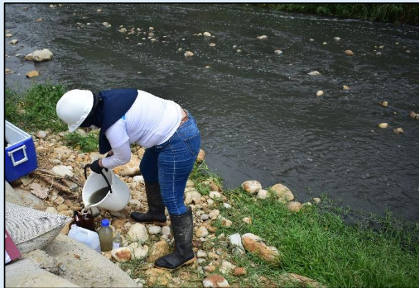
Toma de muestra alícuota para análisis para ensayos fisicoquímicos.
