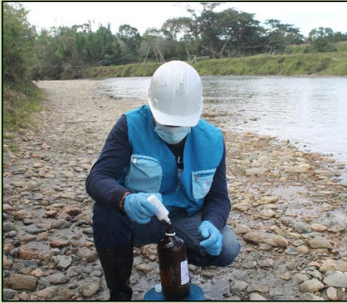
Preservación de muestra para el ensayo de Nitrógeno Total-NT
