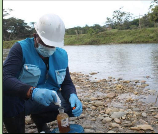
Preservación de muestra para el parámetro de Oxígeno Disuelto.
