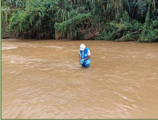
Toma de muestra para el ensayo de Oxígeno Disuelto.
