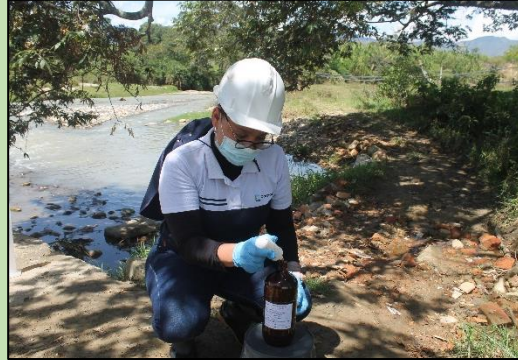
Preservación de muestra para el parámetro de Nitrógeno Total- NT.
