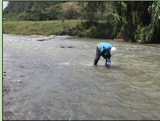
Toma de muestra para el ensayo de Oxígeno Disuelto.
