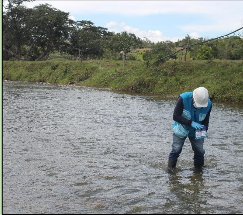
Toma de muestra para análisis para ensayos microbiológicos.
