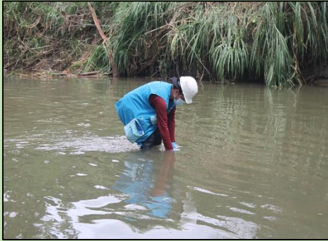
Toma de muestra para análisis para ensayos microbiológicos.
