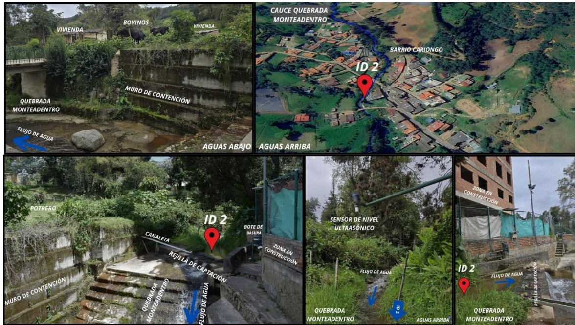
Figura 3 ID2. Estación Limnimétrica -Quebrada Monteadentro.
